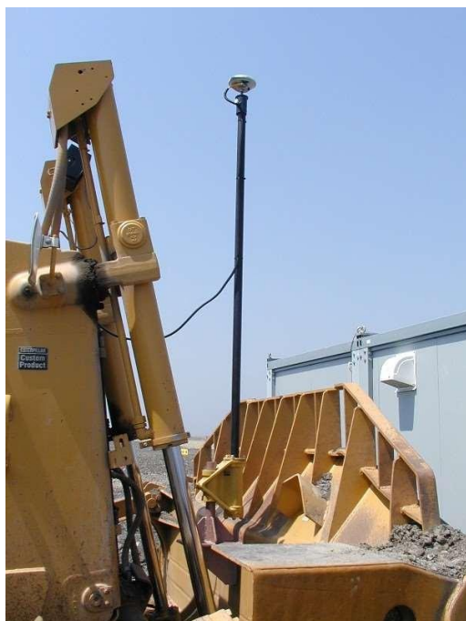
（ 排土板へのGPSアンテナ設置状況）
