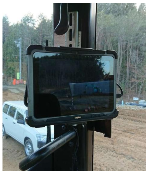
（ キャビン内へのシステム機器設置状況）
