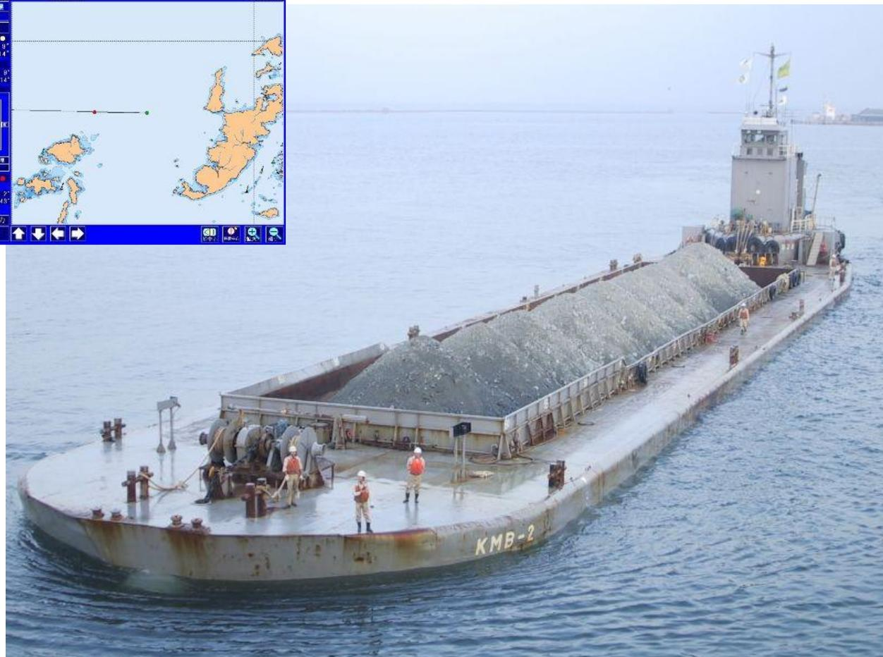
D-NAVIは、土運船に設置したGNSS(GNSSコンパス)を利用して、土運船の土捨位置を管理する施工支援システムです。船体の実測に近い画面表示により、操作者に分かりやすく土捨位置を提供できるほか、投入位置の記録も可能です。また、運航中の航行軌跡の保存も可能であり、トレサビリティ管理にも対応します。システム画面は土運船の操作室だけでなく、無線LANやモバイル通信を利用することにより、押船や引船でも確認することもできます。
